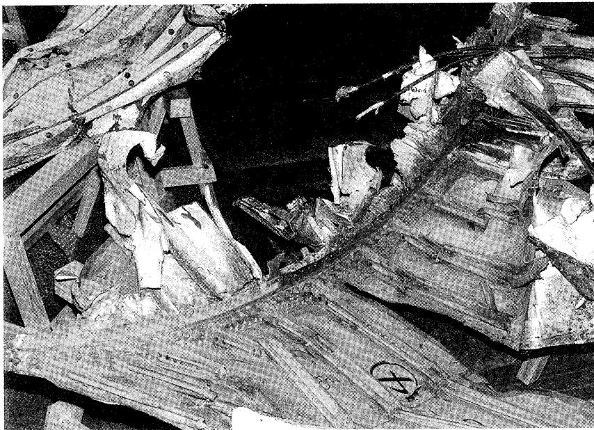
写真- 72 後部圧力隔壁パート4(与圧側)
